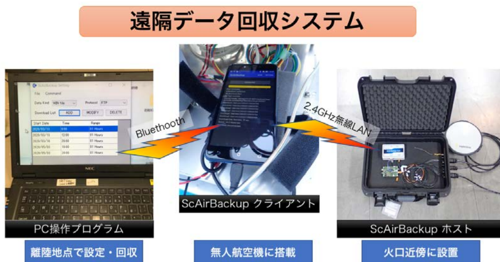
第 8 図 改良された遠隔データ回収システム
